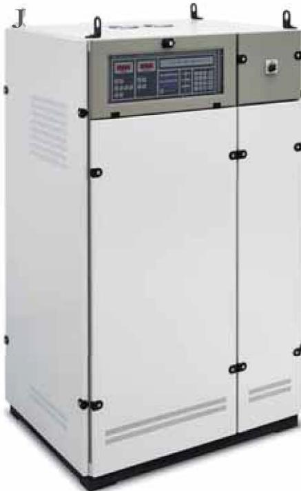
L'HPS 60KVA è un generatore di tensione AC trifase, programmabile in tensione e frequenza, progettato per generare una tensione sinusoidale dalle elevate caratteristiche di purezza, stabilità e precisione. Le sue caratteristiche lo rendono adatto per alimentare qualsiasi apparecchiatura monofase e trifase.
